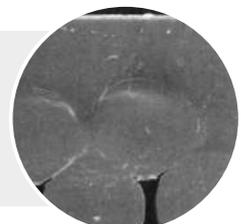
Die **mikroporösen** Folien bestehen aus hydrophoben Polymeren, die nicht in der Lage sind, mit Wasser und Dampf zu interagieren. **Damit die diffusionsoffene Folie atmungsaktiv wird, sind spezielle Bearbeitungen erforderlich**, die sie jedoch steifer und anfälliger für Schadstoffe machen.
