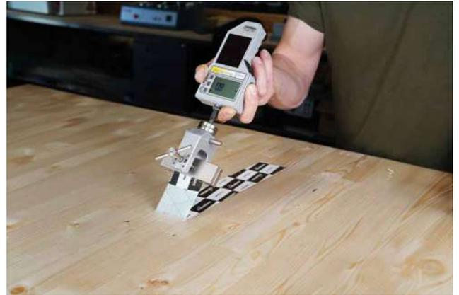
Testreihe zur Kohäsions- und Adhäsionsleistung auf verschiedenen Untergründen der Acryl-Klebebänder.
