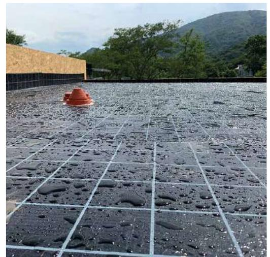
\*Der Test beweist die Qualität von BYTUM BASE 2500 auch bei starkem Regen. Für die Abdichtung von Flachdächern muss das Produkt jedoch in Kombination mit BYTUM SLATE 3500 verwendet werden.
