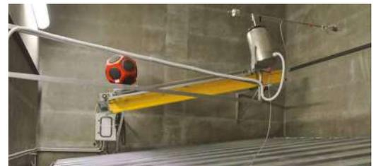
FOTO 1: Foto des Prüfmusters, Emissionsraumseite
